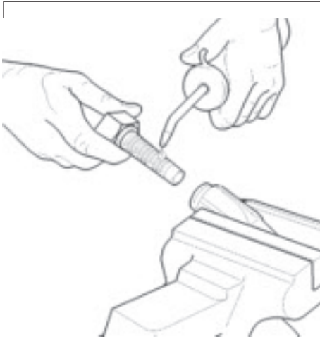
Anschlussnippel einschrauben Screw fitting in clockwise
