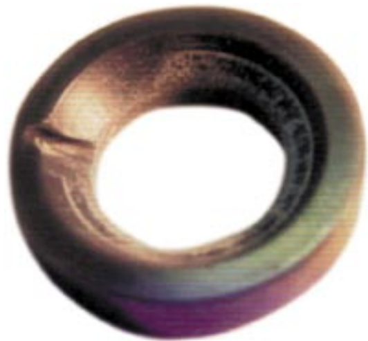
Ungeschützte Kugeldichtung mit Erosionskerbe Unprotected ball seat with erosion groove
