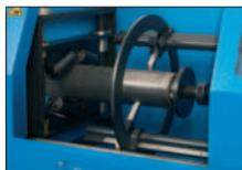
Doppelarm-Schneidewerkzeug mit Schlauch.
