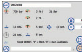
Im einfachen Modus kann ein Artikel aus der Datenbank geladen und die Menge ausgewählt werden; weitere Einstellungen sind nicht möglich. Die Protokolldatei wird erstellt und, falls ausgewählt, automatisch gespeichert.
