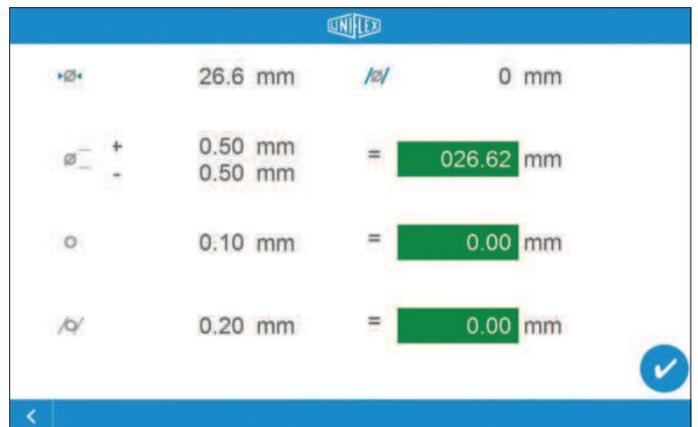
Mit dem Messschieber kann das Ergebnis der Umformung mittels eines frei wählbaren Toleranzbereiches geprüft werden. Dazu das Werkstück an der durch das rote Dreieck angezeigten Stelle messen.
