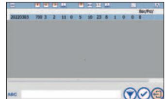
Die Benutzeroberfläche zeigt die Datenbank als eine Liste von Datensätzen, einschließlich Namen und Prüfdaten. Der gewünschte Datensatz wird per Touch ausgewählt und anschließend blau hervorgehoben.
