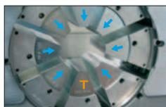
Der feststehende 6-Uhr-Backen ermöglicht das sichere und kraftsparende Positionieren des Werkstückes.
