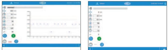
Die Maschinenfähigkeits-Kennzahl (CMK) beschreibt die Fähigkeit der Maschine, die gestellten Anforderungen zu erfüllen. Mit der Funktion CMK in der Steuerung ist es möglich den aktuellen Status der Maschinenfähigkeit laufend während der Fertigung zu überwachen (Integrierter Algorithmus zum Nachweis).
