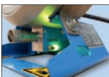
Bei den SH 2 Modellen gibt es ein optisches Signal, wenn das Pressmaß erreicht ist. Die elektrischen Varianten haben eine Stoppautomatik.
