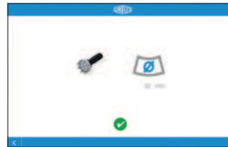
Eingabe von Pressmaßdurchmesser, Korrekturwerten und Pressbacken (automatisch).
