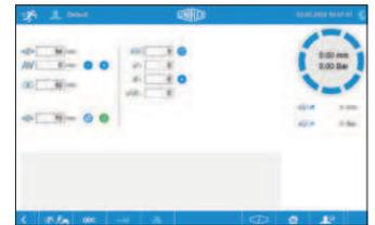
Eingabe von Pressmaß, Korrekturwerten, Haltezeit, Öffnungsdurchmesser, Vorwählzähler und Pressbacken (automatisch).
