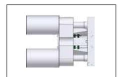
SC = Presswerkzeug mit Zylinder
