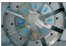
Der feststehende 6-Uhr-Backen ermöglicht das sichere und kraftsparende Positionieren des Werkstückes.
