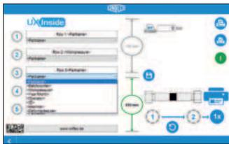
Mit dem Label-Drucker und dem UNIFLEX Label System ULS kann automatisch für jedes Werkstück ein Label gedruckt werden, das anschließend manuell auf das Werkstück geklebt wird. Die Farbcodierung kann in jedem Jahr gewechselt werden, so ist das Alter der Schlauchleitung jederzeit erkennbar.
