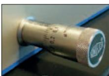
Das Mikrometer ermöglicht es Ihnen Crimpmaße einfach einzustellen. (Control A)
